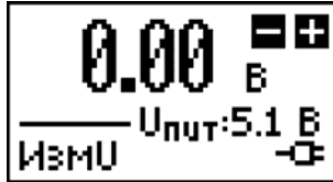
Рисунок 4.3 – Экран прибора в режиме измерения напряжения
