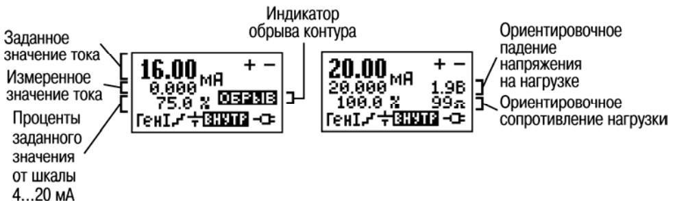
Рисунок 4.4 – Экран прибора в режиме измерения напряжения
